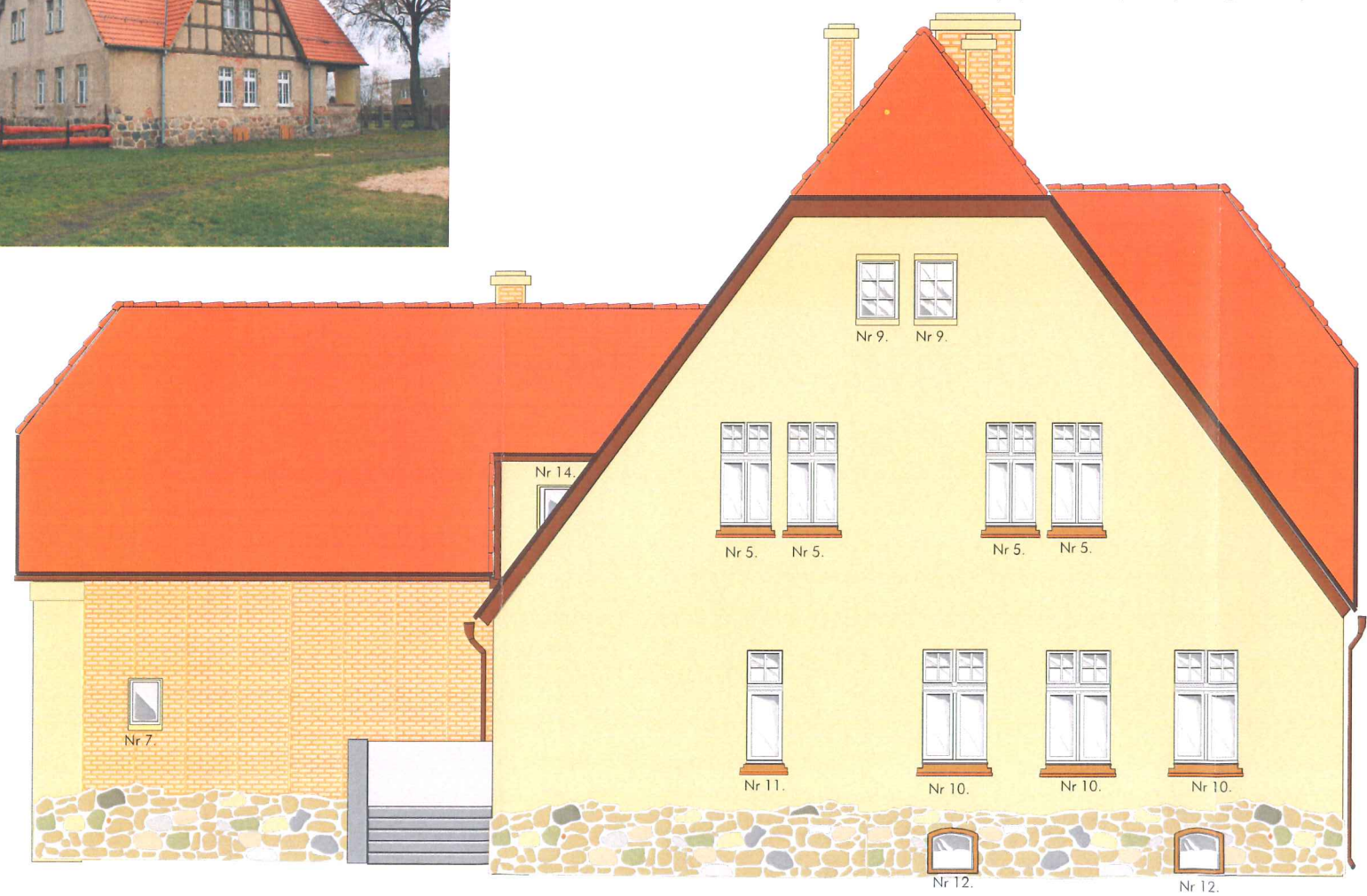
elevacja północna, ściany w cegle do otynkowania i pomalowania, stolarka oznaczona nr do wymiany
