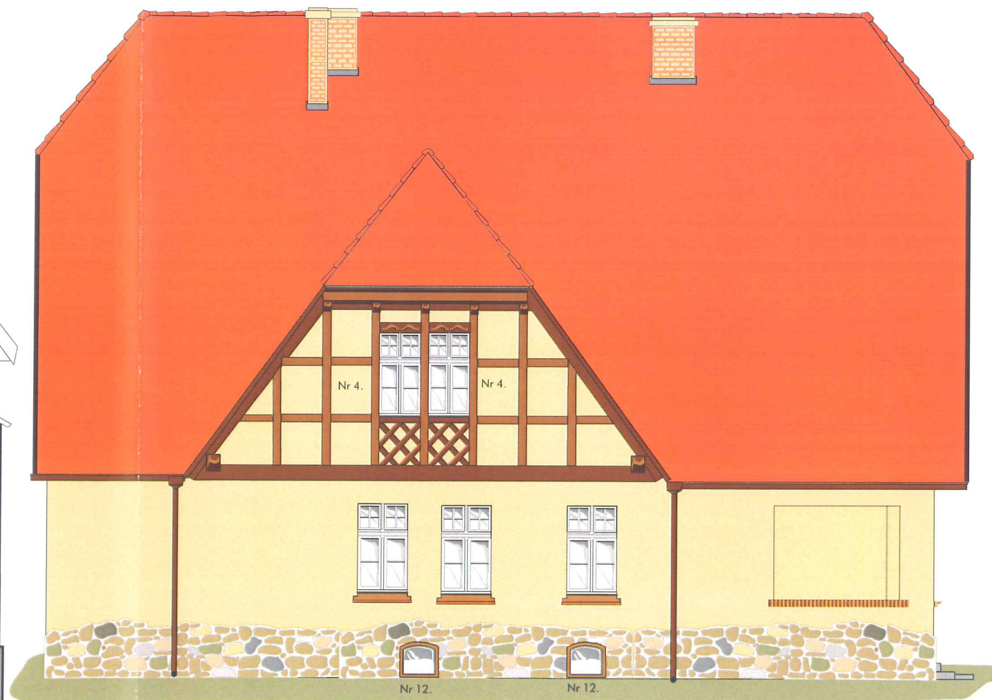
elevacja zachodnia, stolarka oznaczona nr do wymiany
