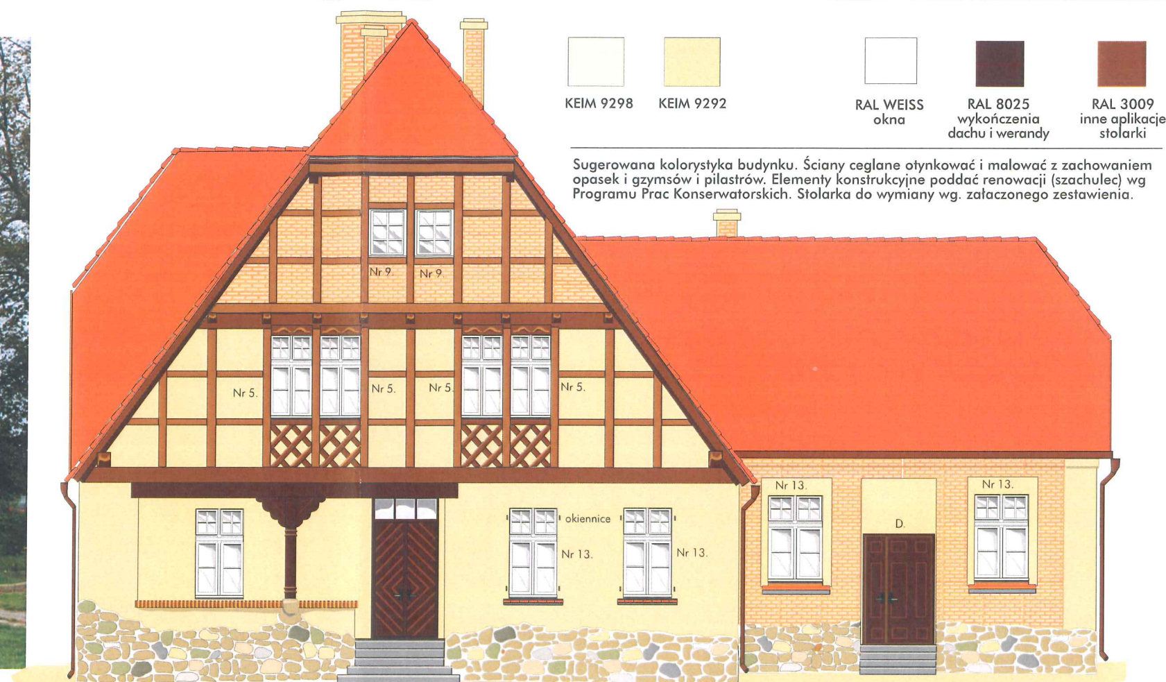
elewacja południowa, ściany w cegle do otyłkowania i pomalowania, stolarka oznaczona nr do wymiany, konserwacja szachulca
