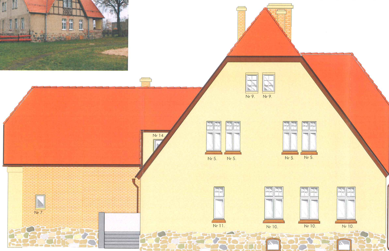
elewacja północna, ściany w cegle do otyłkowania i pomalowania, stolarka oznaczona nr do wymiany
